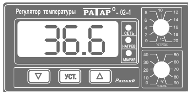
Панель управления и индикации терморегулятора ПАТАР-02-1-Щ1
