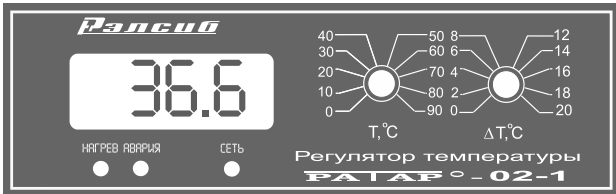
Панель управления и индикации терморегулятора ПАТАР-02-1-Б/к
