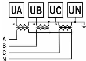
Рис. 7 – Подключение трансформатора напряжения  $x/400$  В (трехфазная цепь с нейтралью)
