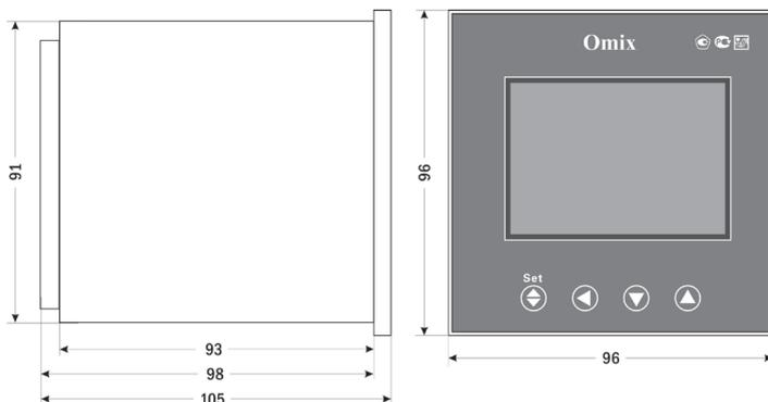
Рис. 3 – Размеры прибора
