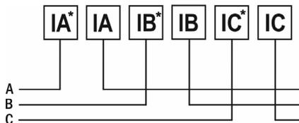
Рис. 10 – Подключение тока напрямую до 5 А
