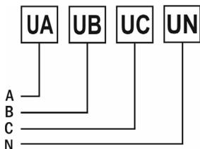
Рис. 6 – Подключение напряжения напрямую до 400 В (трехфазная цепь с нейтралью)
