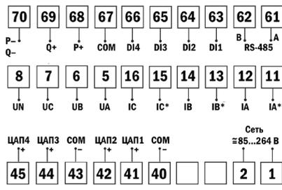
Рис. 5 – Схема подключения
