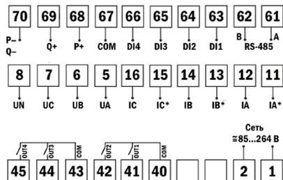
Рис. 6 – Схема подключения P99-MY-3-0.5-4K-RS485
