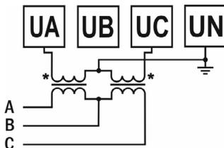
Рис. 9 – Подключение трансформатора напряжения  $x/400$  В (трехфазная цепь без нейтрали)
