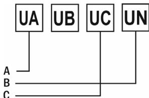
Рис. 8 – Подключение напряжения напрямую до 400 В (трехфазная цепь без нейтрали)
