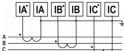
Рис. 11 – Подключение трансформатора тока  $x/5$  А
