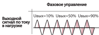
Диаграмма срабатывания твердотельного регулятора KIPPRIBOR с фазовым управлением.
